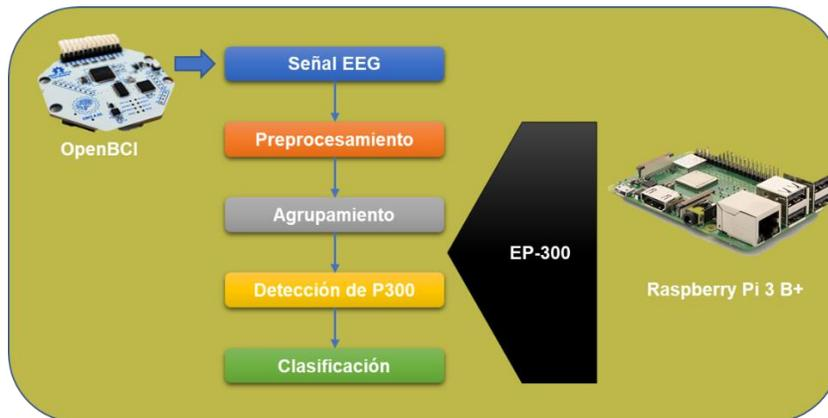
Figura 7. Esquema general de PE-P300.
