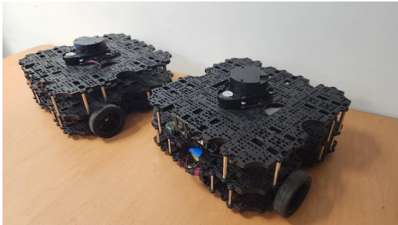
Figura 8: Plataforma móvil Turtlebot3® Waffle Pi.
