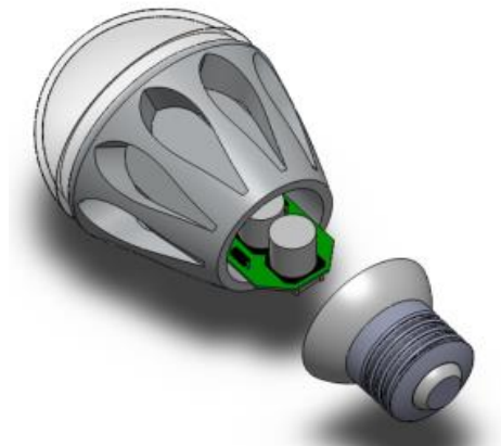
Figura 5. Imagen CAD que muestra el ensamble de los componentes que integran la lámpara LED construida para el estudio.
