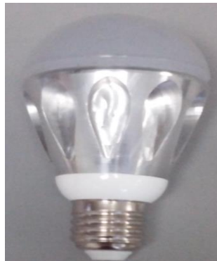
Figura 3. Lámpara LED construida para la implementación y validación del modelo matemático de la disipación de calor generado durante la operación de la misma.
