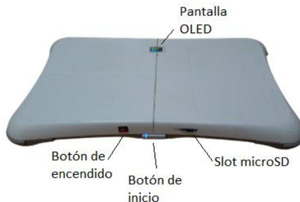
**Fig. 4 Presentación final de la WBBm con sus partes principales.**
