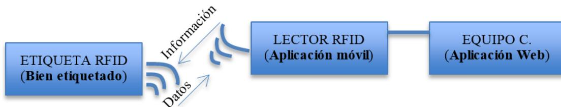
**Figura 2.** Estructura básica de un sistema RFID.
