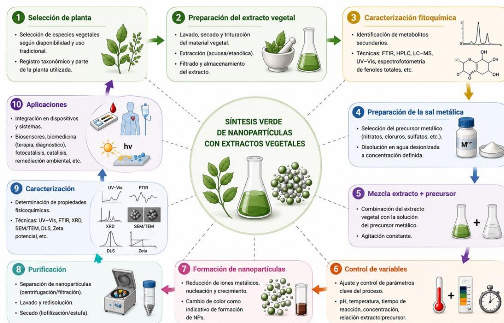
Figura 3. Flujo general del proceso de síntesis verde de nanopartículas empleando extractos vegetales. Imagen generada por IA
