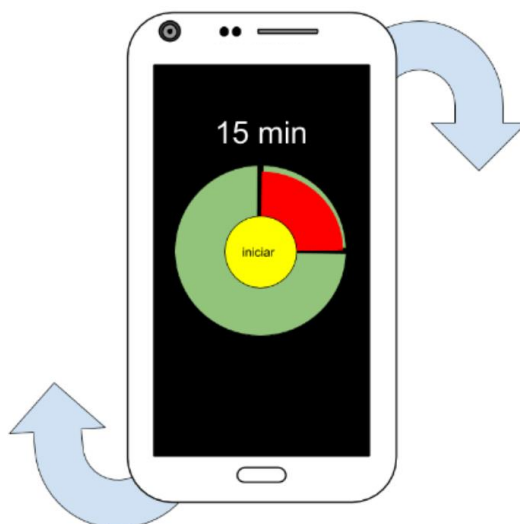
Figura 4. Ejemplo de interfaz para un temporizador con interacción física (controlada mediante sensores de movimiento)
