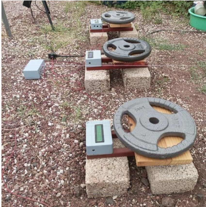
Figura 2. Pruebas de funcionamiento automático en tres instrumentos para pesar (capacidad 5 kg).
