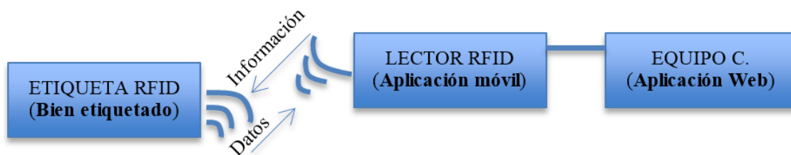
Figura 2. Estructura básica de un sistema RFID.
