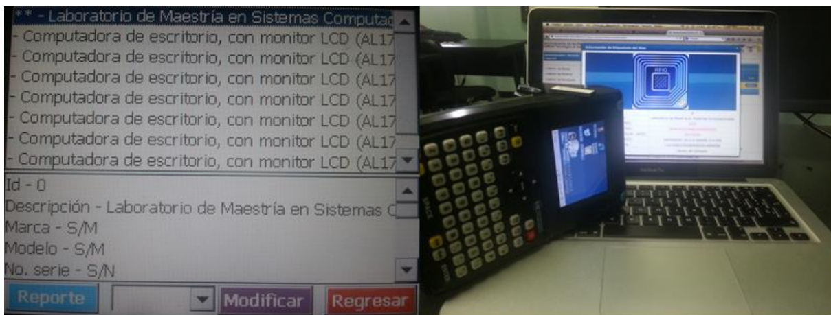
Figura 7. Consulta de etiquetas RFID, integración de la aplicación Web y móvil
